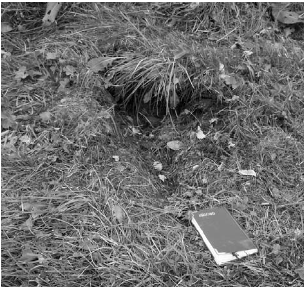
Fig. 10: Einschlagtrichter eines Steines im weichen Boden. Das Projektil ist in einem Winkel von weniger als 30° rund 25 cm eingedrungen.
