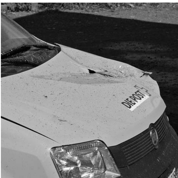
Fig. 9: Schlagspuren durch Steinschlag an PW vor der Talstation.
