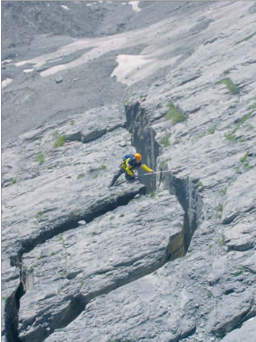
Fig. 2: Der Ablösespalt der grossen Felsbewegung «Eiger» in Grindelwald in der Anfangsphase am 20. Juni 2006. Der Spalt wurde am 10. Juni 2006 entdeckt. Die über zwei Mio. m 3 grosse Felsmasse bewegt sich mit 0.15 m pro Tag in den Gletscher hinein.
