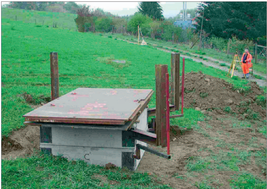
Fig. 1: Versuch Nr. 1 bei einer Last von 200 kN.
